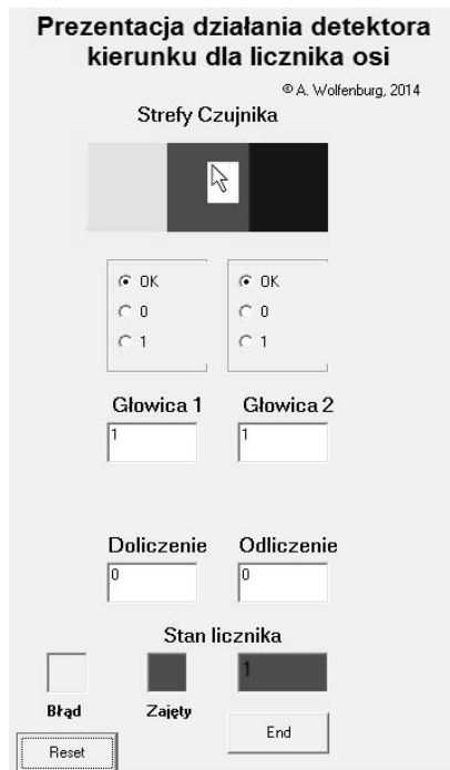
Rys. 10. Okno programu symulującego działanie układu mikroprocesorowego [oprac. autor]
