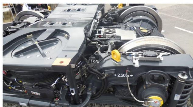
Rys. 19. Widok wózka napędowego FLEXX do pociągu Twindex Express w dwóch rzutach z tarczami jednostronnymi zamocowanymi do tarczy koła
