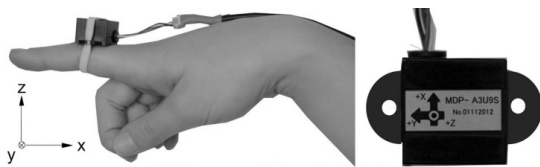
Rys. 1. Po lewej: umiejscowienie czujnika na dłoni podczas wykonywania gestów wraz z odniesieniem do związanego z nim układu współrzędnych. Po prawej: czujnik NEC-TOKIN, Motion Sensor MDP-A3U9S
