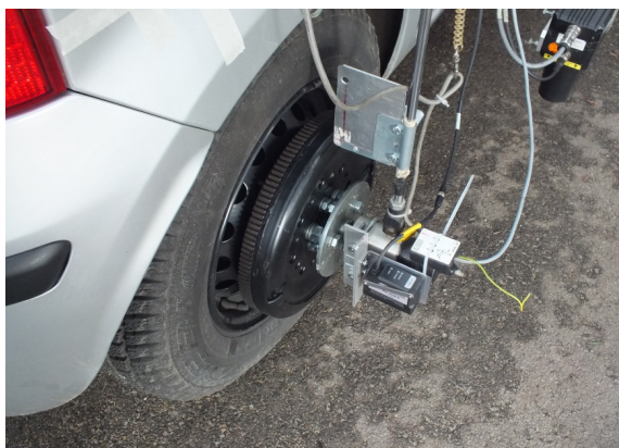
Rys. 7. Widok masy zastępczej imitującej wirnik silnika
