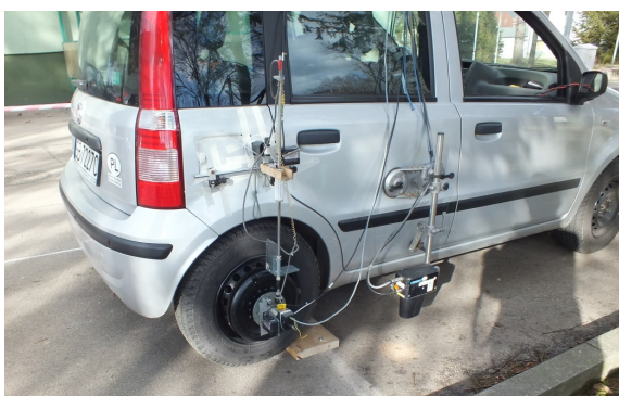
Rys. 8. Obiekt badań z zamontowaną aparaturą pomiarową podczas pokonywania nierówności jezdni przez koło
