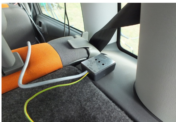
Rys. 9. Czujnik przyspieszenia zamontowany na nadwoziu pojazdu nad kołem
