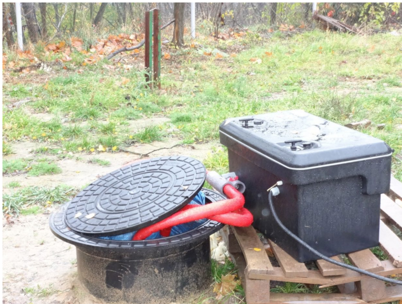
Rys. 4. Urządzenie TRT podczas testowania na otworze badawczym
