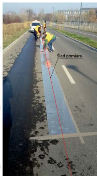
Rys. 5. Wyniki pomiarów właściwości przeciwpoślizgowych nawierzchni na odcinku o wyraźnie zmiennej szorstkości nawierzchni
