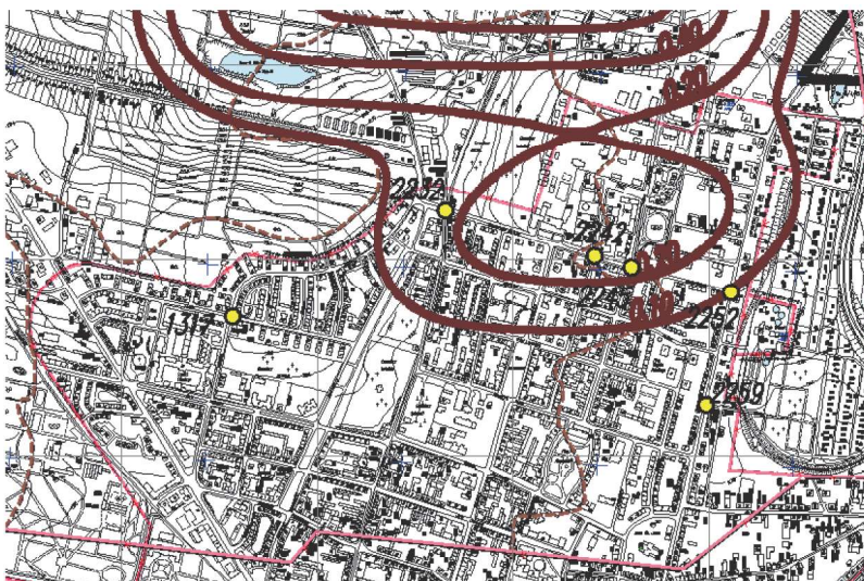
Rys. 7. Izolinie obniżeń w granicach terenu chronionego pod wpływem eksploatacji dokonanej w latach 2010 - 2015
