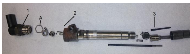
Rys. 2. Wtryskiwacz piezoelektryczny Siemens z podziałem na strefy: strefa 1 – kryształ piezoelektryczny, 2 – komora sterująca pracą wtryskiwacza z zaworami, 3 – zespół rozpylacza paliwa
