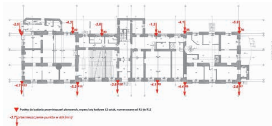
Ryc. 22. Wyniki pomiarów przemieszczeń pionowych punktów kontrolnych
