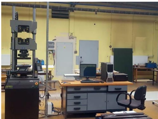
Rys. 3. Elementy systemu do badań wytrzymałościowych INSTRON – stanowisko do badań wytrzymałościowych wraz z oprogramowaniem Bluehill 2
