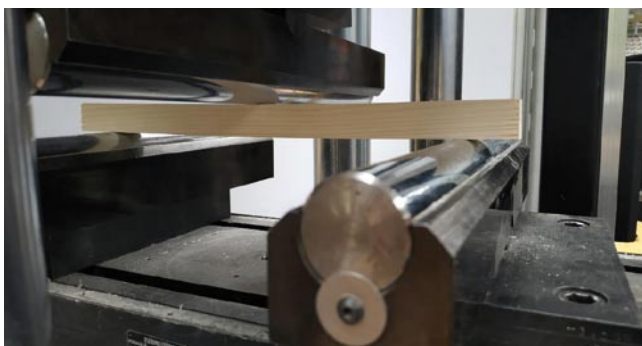
Rys. 8. Umieszczenie próbki do badania wytrzymałości na zginanie statyczne w głowicy maszyny wytrzymałościowej
