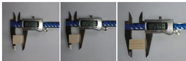
Rys. 4. Pomiar próbki względem kolejnych osi symetrii
