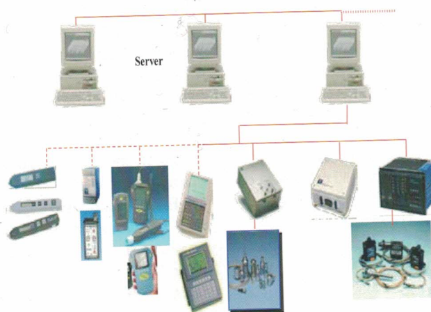
Rys. 9. Uproszczony schemat ideowy zintegrowanego system diagnostyki w danym zakładzie przemysłowym wg SKF [15]
