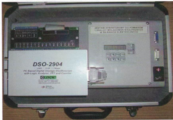
Rys. 23. Przenośny zestaw aparatury do pomiarów i analizy wnz w silnikach elektrycznych produkcji własnej [17, 18]
