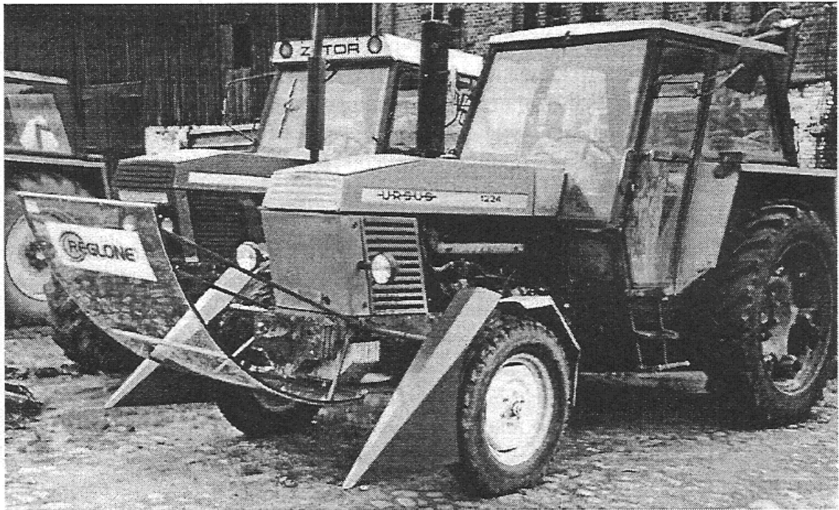
Rys. 1. Ciągnik agregatu opryskującego z ekranem, fartuchem i rozdzielaczami łąnu
