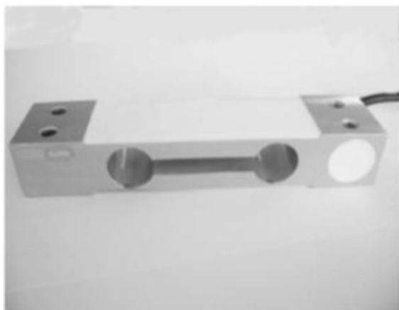
Rys. 4. Belka tensometryczna typu BTENS-NI-040
