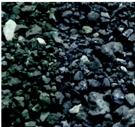
Rys. 1. Granulat asfaltowy 31,5 RA 0/22,4: a) przed ekstrakcją; b) mieszanka kruszywa wyekstrahowana z granulatu asfaltowego
