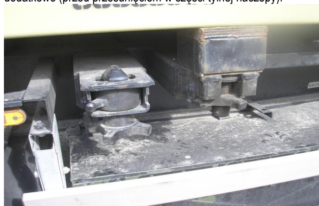
Fot. 5. Widok mocowania kontenera do elementów naczepy
