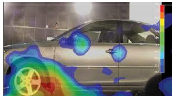
Rys. 1. Mapa akustyczna pojazdu z uruchomionym silnikiem w tunelu aerodynamicznym [3]
