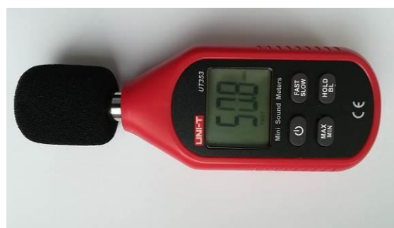
Fot. 3. Miernik UNI-T Mini Sound Meters [fot. T. Perzyński]
