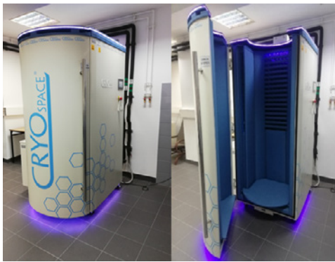
Ryc. 1 Kriokomora wykorzystywana do badań z agregatem umożliwiającym uzyskanie nawiewu o temperaturze 0°C wewnątrz, bez stosowania ciekłego azotu Źródło: Materiał własny.
