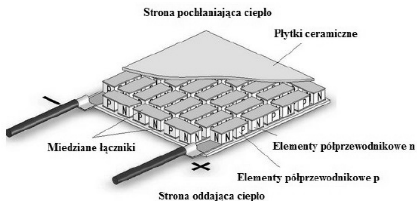
Rys. 2. Budowa ogniwa Peltiera [2]
