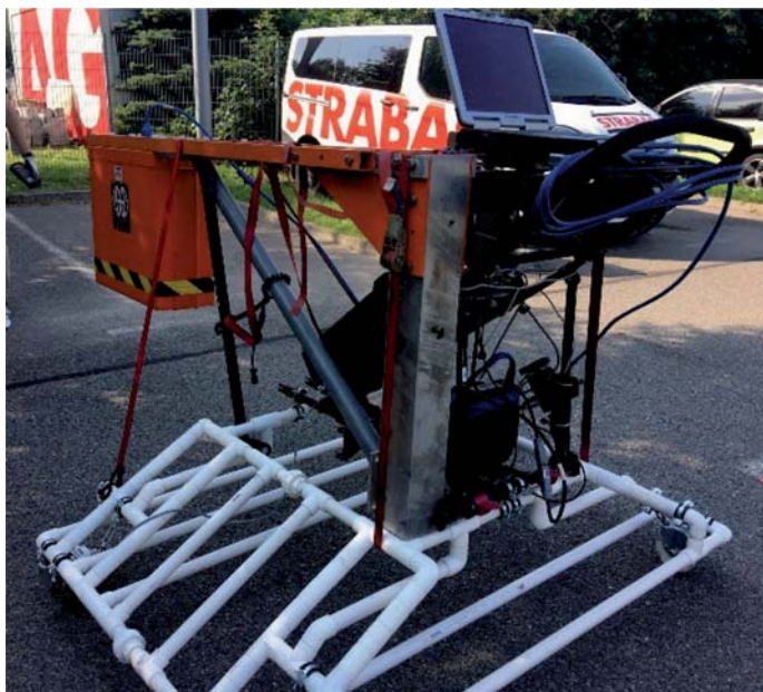
Rys. 16. Prototypowy wózek do montażu anteny sprzężonej z powietrzem
