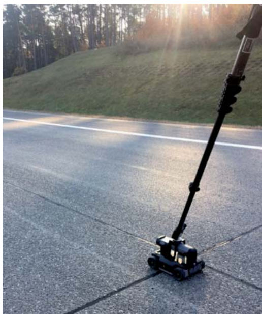
Rys. 6. Pomiar rozstawu kotew pomiędzy sąsiadującymi płytami za pomocą georadaru g-c o częstotliwości krokowej od 0,2 do 4,0 GHz
