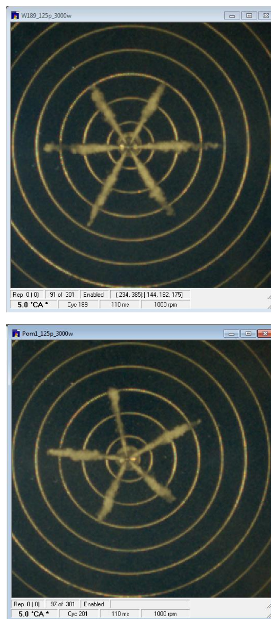
Rys. 1. Widok strug paliwa sfotografowany po 5^\circ obrotu wałka pompy od rzeczywistego początku wtrysku dla dwóch badanych wtryskiwaczy W189 i Wpom ( t_{wtr} = 3 ms, p_{rail} = 125 MPa, n = 1000 obr/min)
