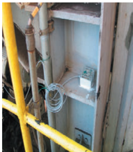
Rys. 5. Autonomiczny rejestrator dwukanałowy z pomiarów tensometrycznych
