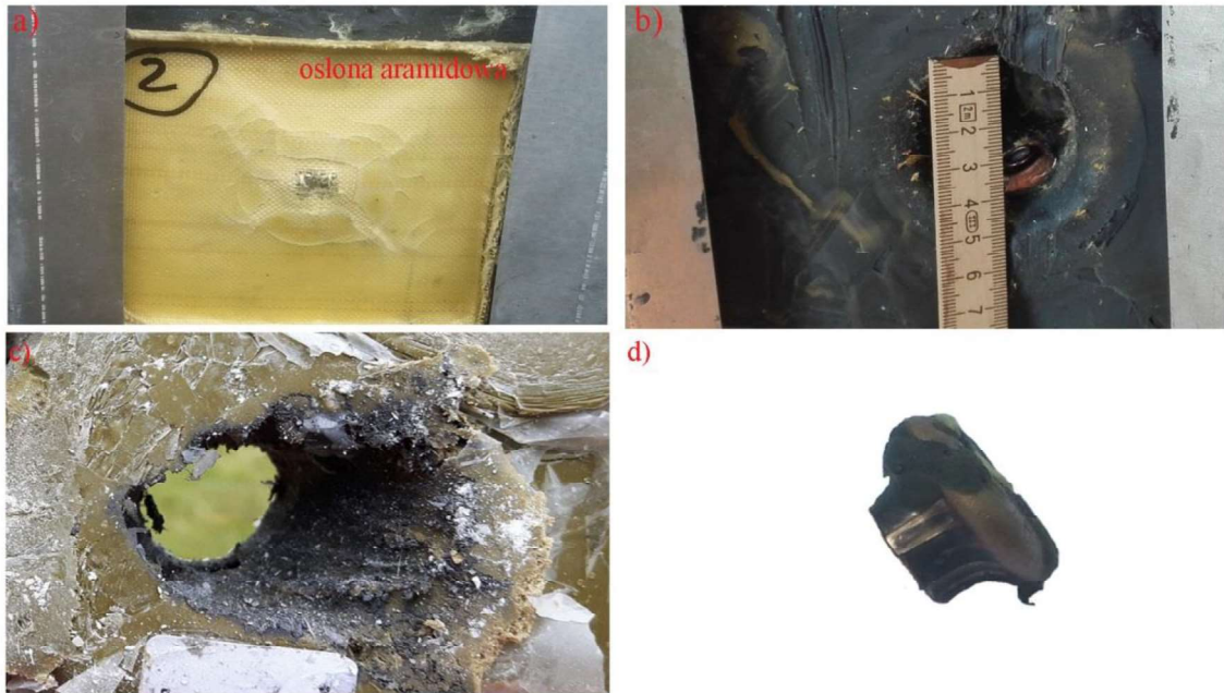
Rys. 11. Kawitacja 9 mm pocisku Parabellum w bloku plasteliny balistycznej w wyniku przestrzelenia układu aramidowego: a) ostrzelany układ nabojem 9x19 mm z pistoletu maszynowego PM-84p przy prędkości v_0 = 355 m/s, b) charakterystyczny otwór wejściowy wraz jamą trwałą, c) otwór wyjściowy, d) zdeformowany pocisk
