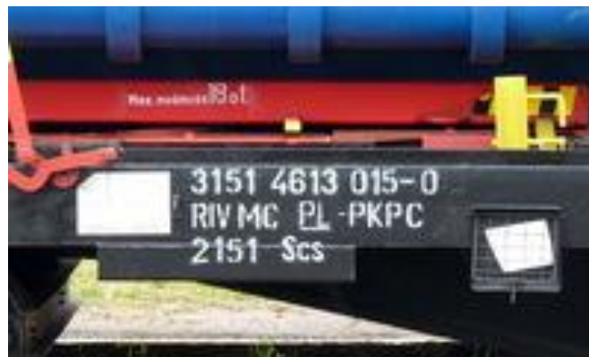
Rys. 4. Przykład oznaczeń na wagonie wg pierwszego schematu Źródło: www. PKP Cargo.pl
