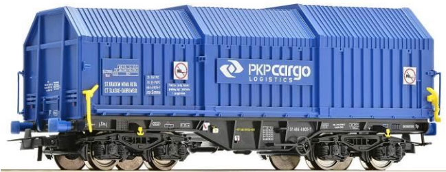
Rys.31. Przykład wagonu Simms Źródło: www. PKP Cargo.pl Wagon typu U (Uai) jest przeznaczony do przewozu ciężkich ładunków o przekroczonej skrajni (rys. 32 i 33).
