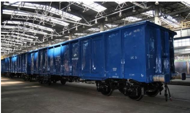
Rys.13. Przykład wagonu typu E Źródło: www. PKP Cargo.pl Wagon typu F (Falns), przeznaczony do przewozu węgla, kruszyw, materiałów sypkich niewrażliwych na działanie warunków atmosferycznych (rys. 14 i 15).
