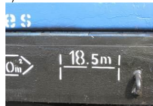
Rys.11. Przykład oznaczeń na wagonie: a) oznaczenie długości ładunkowej, b) oznaczenie długości ze zderzakami Źródło: zasoby własne
