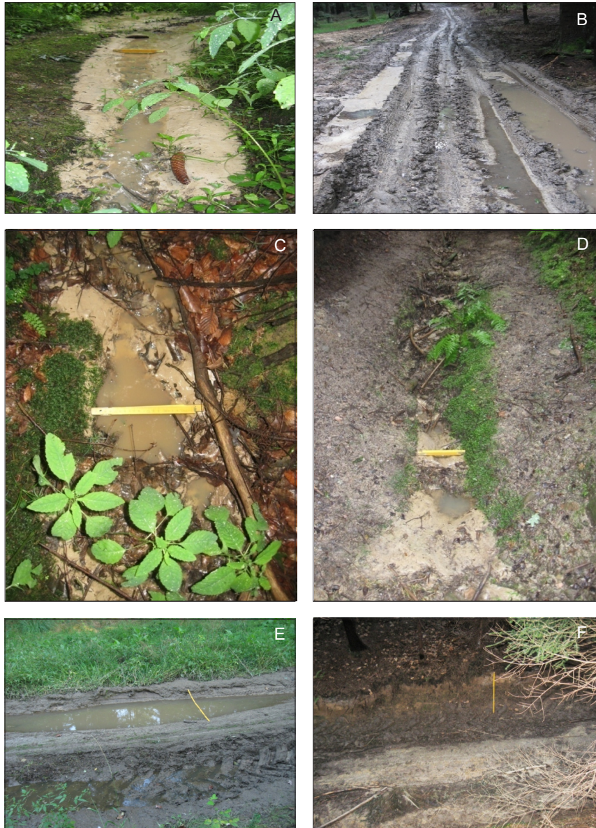
Ryc. 7. Mikroformy w obrębie dróg (fot. A. Natanek). A. Żłobiny w obrębie drogi powstałe na skutek erozji liniowej; B. Koleiny powstałe po przejeździe maszyn leśnych; C. Kociołek eworsyjny na drodze częściowo zadarnionej; D. Rozcięcie liniowe na drodze, w obrębie którego zachodzi akumulacja materiału; E. Zagłębienie bezodpływowe powstałe po przejeździe maszyn leśnych i wypełnione wodą pochodzącą z opadów deszczu; F. Podcięcie drogowo w obrębie holwegu będące źródłem materiału do transportu podczas opadów lub roztopów
