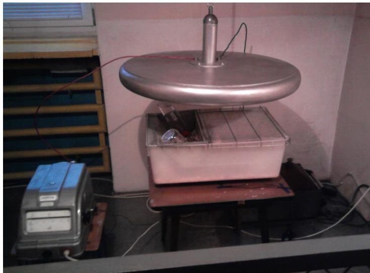
Rys. 1. Sposób ekspozycji zwierząt na działanie pola elektromagnetycznego
