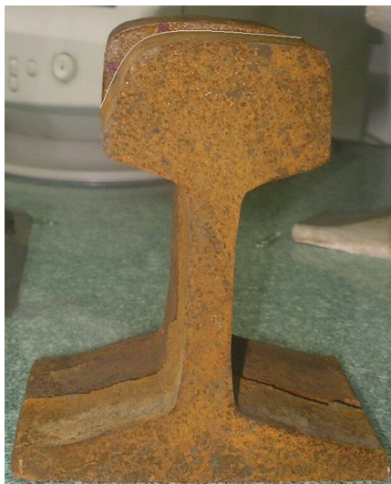
Rys. 2. Próbkę analizowanego stopnia zużycia szyny E491
