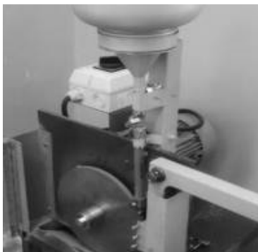
Fig. 3. Photo of tribotester setup for three-body abrasion Rys. 3. Fotografia tribotestu do badania zużycia ściernego z trzecim ciałem
