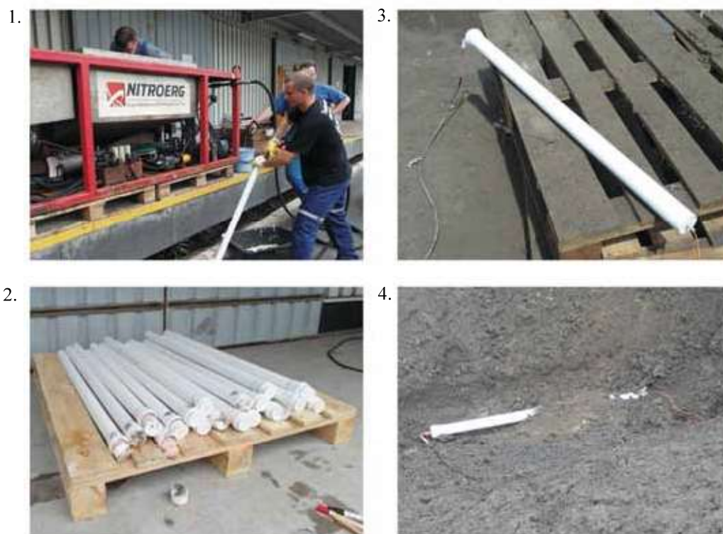
Rys. 2. Proces przygotowania prób: 1 – ładowanie MWE luzem do rur kanalizacyjnych; 2 – proces nagazowywania i transport prób na plac odpalania; 3 – podłączanie sondy pomiarowej oraz zapalnika; 4 – przysypywanie ładunków MWE gotowych do odpalania Fig.2. The process of sample preparation: 1 – charging bulk emulsion explosives into the sewer pipe; 2 – storing and transport of samples to the detonation field; 3 – connecting the measurement probe and detonator; 4 – covering the emulsion explosives ready for blasting
