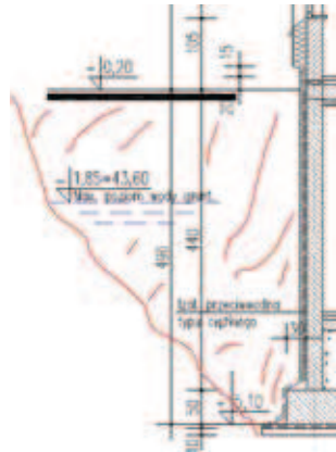
Rys. 5. Zakres wykonanych zasypek – gruntem niespoistym
