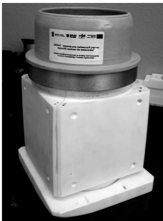
Rys. 1. Widok rdzennicy, do utwardzania mas ze szkłem wodnym w polu mikrofalowym, wykonanej z materiału PTFE
