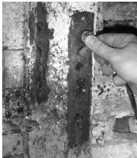
Rys. 3.2 Przykładowy pomiar elementów kształownika w warunkach „in situ”: a) pomiar grubości ścianki kształownika, b) pomiar grubości dna kształownika
