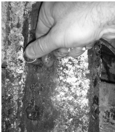
Rys. 3.2 Przykładowy pomiar elementów kształownika w warunkach „in situ”: a) pomiar grubości ścianki kształownika, b) pomiar grubości dna kształownika
