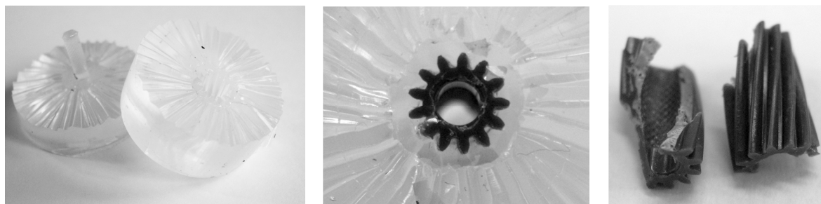
Rys. 7. Po lewej - forma silikonowa, w środku forma wypełniona żywicą, po prawej - uszkodzony odlew z żywicy EPO 5019 Fig. 7. On the left – silicone mold, in the middle – mold filled with resin, on the right – damaged casting out of EPO 5019
