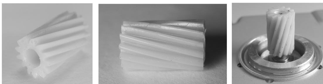
Rys. 8. Po lewej i w środku - odlew koła z żywicy F19, po prawej - koło osadzone na wale silnika elektrycznego Fig. 8. On the left and in the middle – gears out of F19 resin, on the right – gear mounted on the shaft of the electric engine
