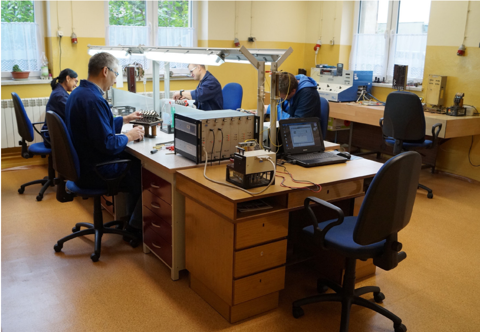
Rys. 4. Stanowiska do regulacji i sprawdzania przekaźników w punkcie OTP w Tarnowskich Górach
