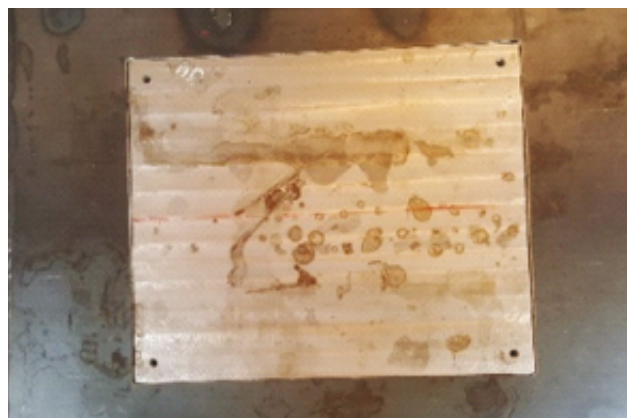
Rys. 6. Próbkę referencyjna #28 do weryfikacji nastaw systemu ultradźwiękowego PA+TOFD
