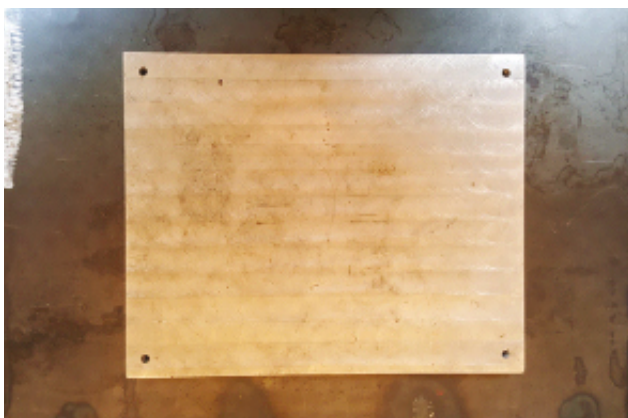
Rys. 5. Próbkę referencyjna #15 do weryfikacji nastaw systemu ultradźwiękowego PA+TOFD.
