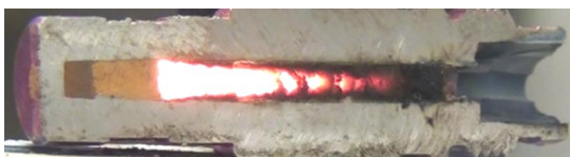
Fot. 1. Proces spalania PMO (pirotechnicznego ładunku opóźniającego) [11]
