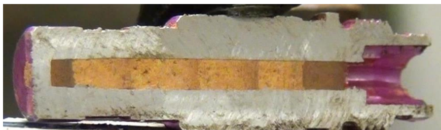
Fot. 3. Przekrój osiowy PŁO z zapalnika UZRGM z warstwowym zaprasowaniem PMO Photo 3. Axial cross section of PDC from UZRGM fuse with pressed layers of PDM
