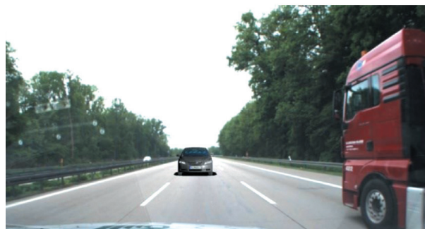
Rys. 4. Kadr z filmu z rzeczywistej jazdy testowej rozszerzony o samochody wirtualne [7]
