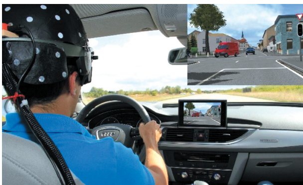
Rys. 12. Rzeczywista jazda testowa rozszerzona o wirtualne samochody [20]
