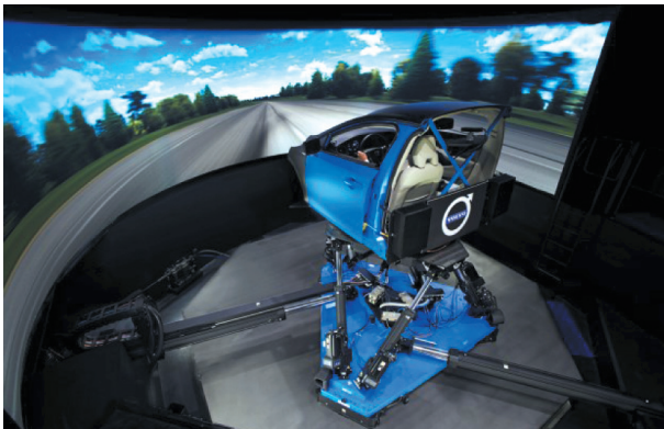
Rys. 5. Symulator dynamicznej jazdy marki Volvo [6]
