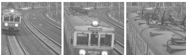
Rys. 6. Komplet fotografii dla wybranego pociągu umożliwiających identyfikację pojazdu i określenie uniesionych odbieraków
