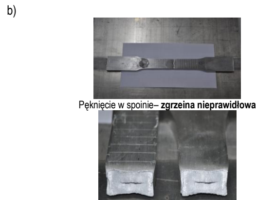
Przelom próbki złącza spajanego tarcowo stopu 7020 po próbie statycznego zrywania przy 52% większej prędkości obrotowej trzpienia
