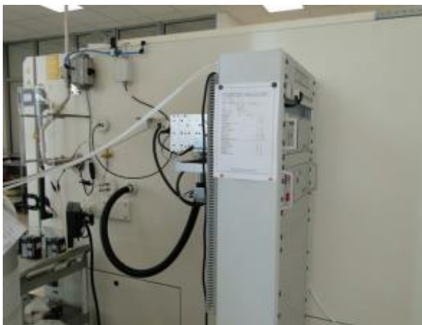
Rys. 2. Detektor FID połączony z wnętrzem komory ogrzewaną linią transferową
