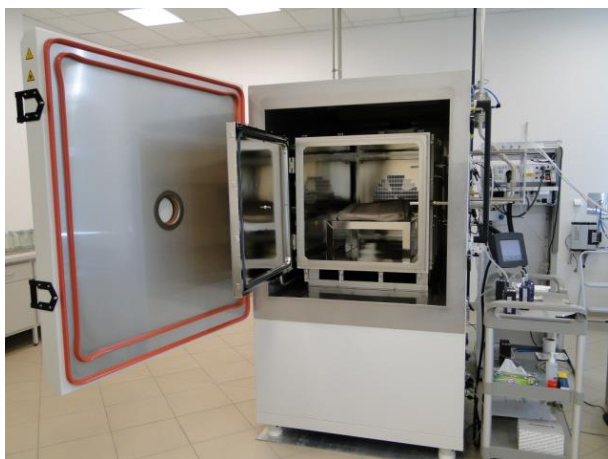
Rys. 1. Komora Weiss WKE1000 do badania emisji z materiałów
