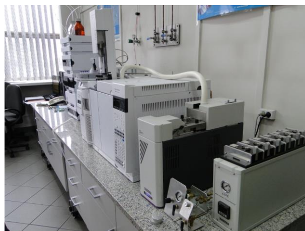
Rys. 3. Układ chromatografu gazowego GC-FID/MS wraz z termodesorberem, pierwszy z prawej – zestaw mikrokomór badawczych
