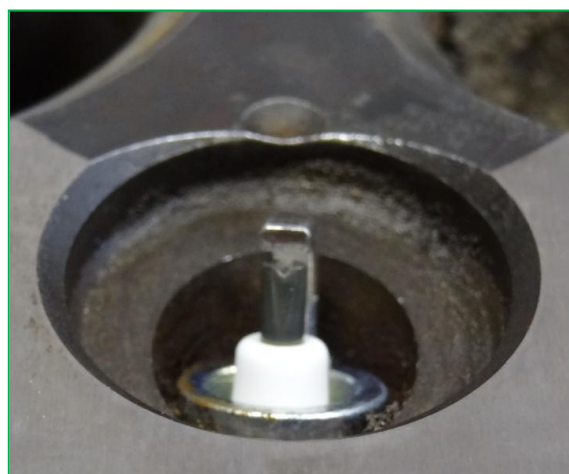
Rys.4. Fabryczna i specjalna świeca zapłonowa stosowana w badaniach w głowicy silnika MAN
