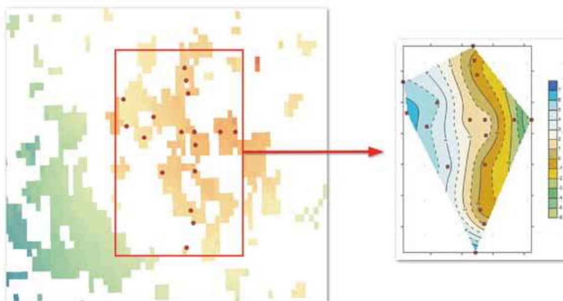
Rys. 6. Porównanie wyników interferometrii radarowej z pomiarami niwelacyjnymi w postaci rozkładu wartości błędów względnego wyrażonego w procentach (%)
