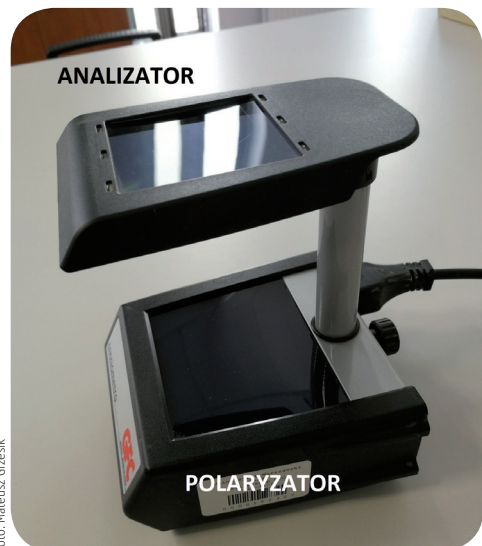
Rys. 3. Zdjęcie polaryskopu z polaryzatorem i analizatorem
