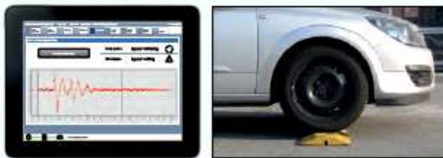
Rys.4. Badanie stanu amortyzatorów z zastosowaniem czujnika przyspieszeń nadwozia, rejestracja drgań testerem PTI [8]
