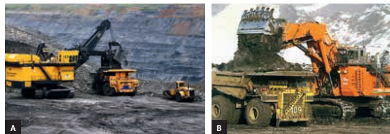
Ryc. 9. Koparki w kopalniach odkrywkowych: a) linowa P&H (obecnie Joy Global) 2800XPB [10], b) hydrauliczna nadsiębierna [9]
