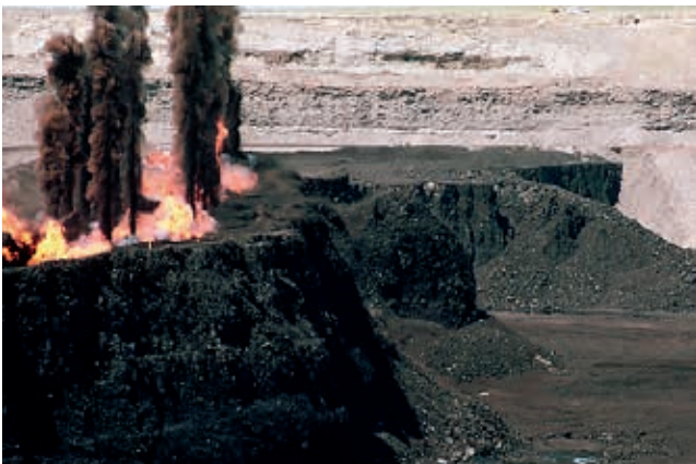
Ryc. 11. Rozluźnianie calizny skalnej z użyciem MW w kopalni odkrywkowej węgla kamiennego [16]
