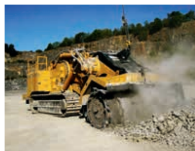
Ryc. 14. Kombajn frezujący Vermeer TL1255 [13]
