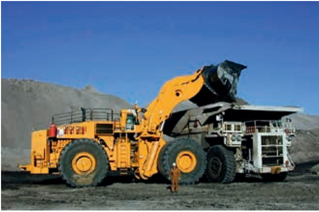
Ryc. 17. Ładowarka LeTourneau L-2350 [30]
