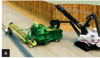
Ryc. 18. Współpraca jednonaczyniowej koparki linowej z mobilnym zakładem przerobczym: a) schemat układu, b) widok na pracujący układ [24]
