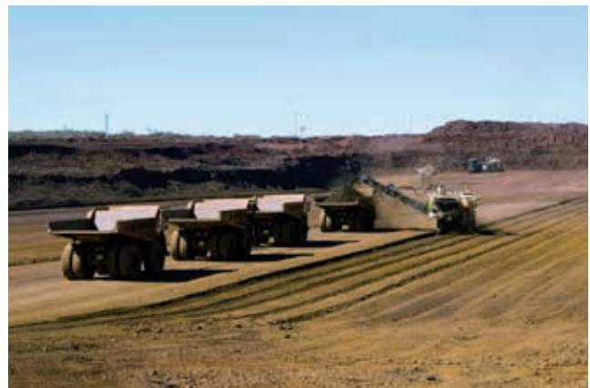
Ryc. 13. Kombajn frezujący Wirtgen 4200SM z bezpośrednim ładowaniem urobionej kopaliny na wozidła [28]
