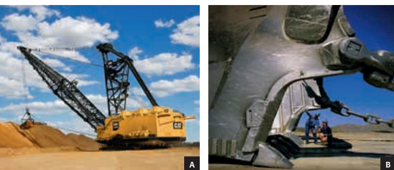
Ryc. 7: a) Koparka zgarniakowa Caterpillar 8750 na podwoziu kroczącym o pojemnościach zgarniaka 76–116 m 3 oraz długości wysięgnika 109,7–132,5 m [17], b) zgarniak koparki w kopalni węgla kamiennego (Australia) [14]
