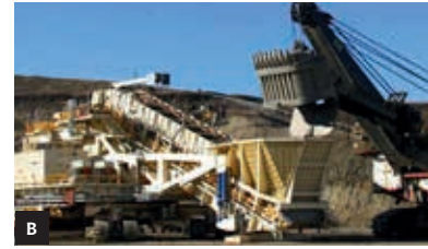
Ryc. 18. Współpraca jednonaczyniowej koparki linowej z mobilnym zakładem przerobczym: a) schemat układu, b) widok na pracujący układ [24]
