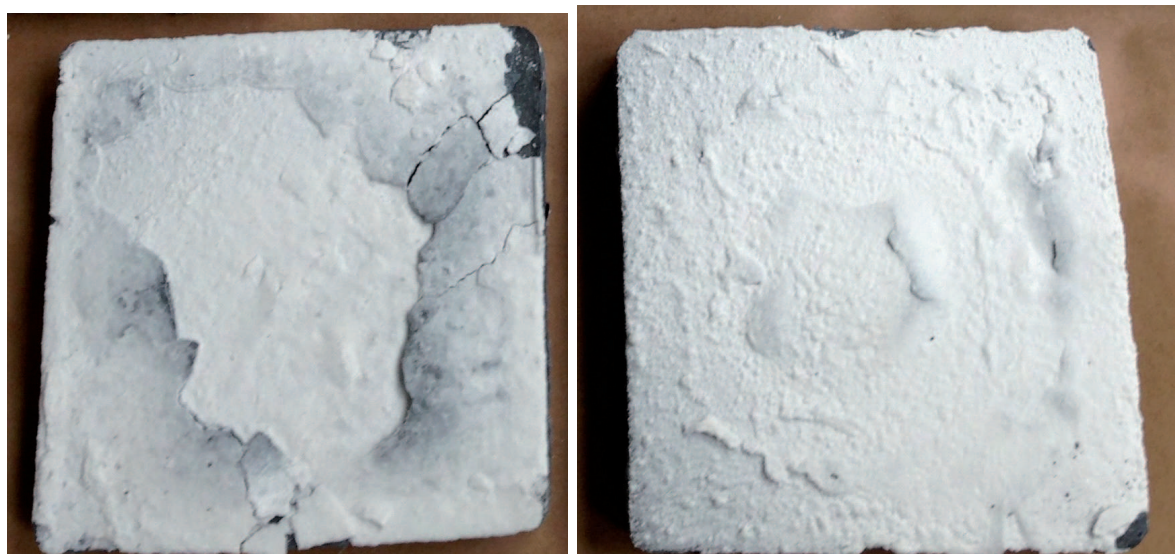
Ryc. 4. Płytki napyłone w temperaturze 850°C: a) powłoka A, b) powłoka B
