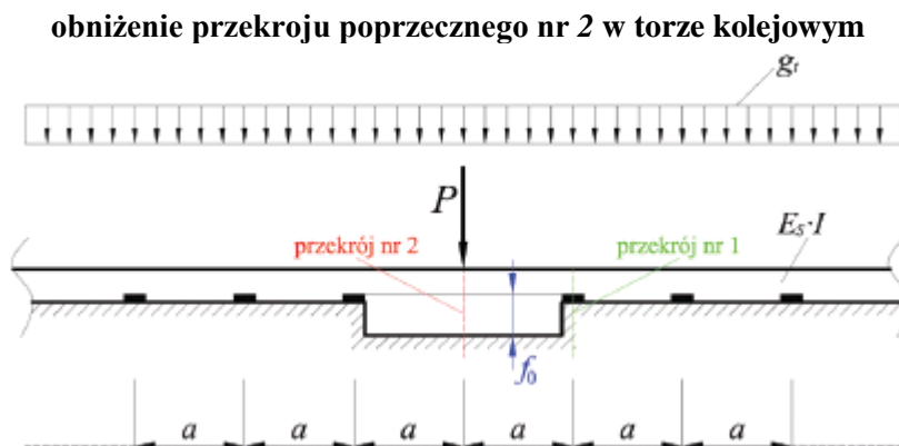
Rys. 5. Schemat wywołanej nierówności w torze kolejowym [3]. f_0 – nierówność wywołana w torze kolejowym [mm]; P – przyłożona siła [MN]; E_s \cdot I – sztywność toru w płaszczyźnie pionowej [ \text{MNm}^2 ]; g_r – ciężar toru [ \text{MN/m} ]; a – rozstaw podkładków [m]
