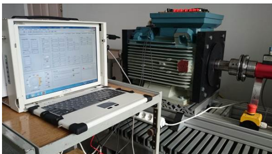
Rys.2. Kontroler PXI na stanowisku dynamometrycznym.
