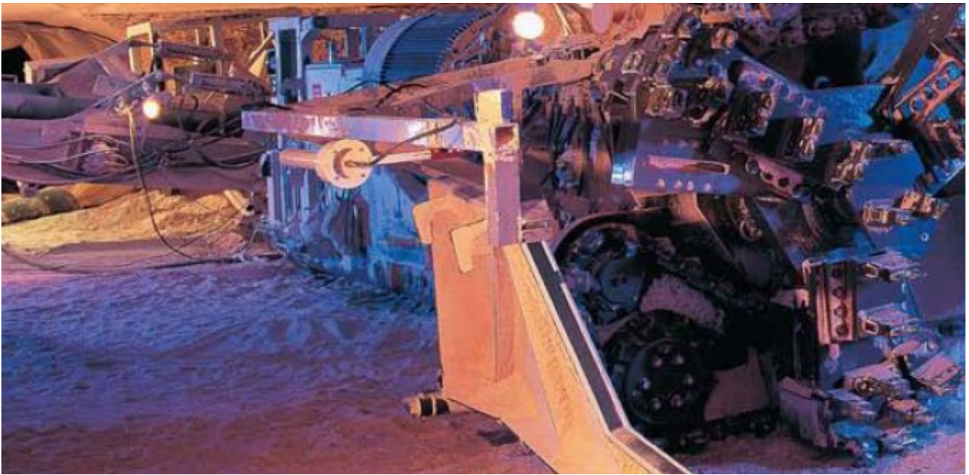
Ryc. 2. Maszyna typu „marietta” w kopalni soli potasowej; USA
