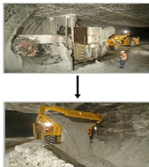
Ryc. 7. Cykl produkcyjny w przypadku urabiania mechanicznego
