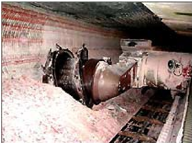
Ryc. 3. Eksploatacja złóż soli potasowej metodą ścianową w jednej z kopalń Belaruskali
