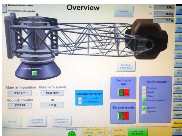
Rys. 5. Widok wirówki przeciążeniowej wykorzystywanej do badania pilotów na oddziaływanie przeciążeń liniowych
