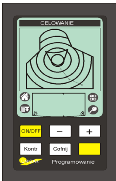
Rys. 2 - Urządzenie (palmtop) do programowania ćwiczeń na BTL.
